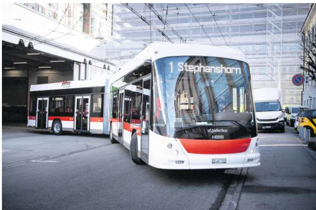
16 solcher Batterietrolleybusse sollen in der zweiten Etappe der VBSG-Flottenerneuerung angeschafft werden, um das Busnetz weiter zu elektrifizieren.
